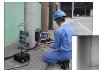
X線透過診断 (模擬試験体での撮影写真)
