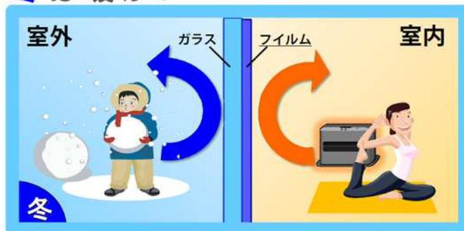
暖房機からの熱を反射し、戸外に逃がさず保温して暖房コストを削減します。
