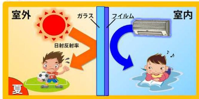
太陽からの熱線を遮断し、室温の上昇を防ぎ冷房コストを削減します。
